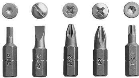
Рис. 3.7. Відповідність шліців шурупів бітам шурупокрутів
