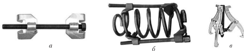
Рис. 25.4. Стяжки для стягування пружин і знімання підшипників: а – для стягування пружин; б – установлення стяжок на пружину; в – для знімання підшипників
