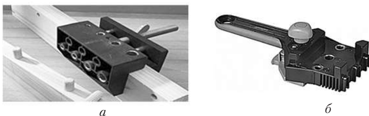
Рис. 7.5. Розмічальні пристрої: а — спеціальний шаблон; б — кондуктор-шкантовач
