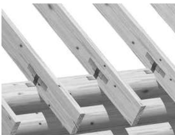
Рис. 36.1. Ковзні з'єднання: а — кріпильний елемент; б — ковзні опори даху
