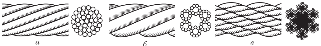
Рис. 34.2. Звивання сталевих канатів: а — одинарне; б — подвійне; в — потрійне
