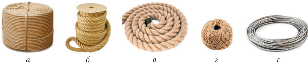
Рис. 33.1. Види мотузок: а — мотузка; б — канат; в — шнур; г — шпагат; r — трос
