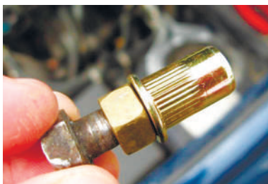
Рис. 52.7. Конструкція різбової заклепки
